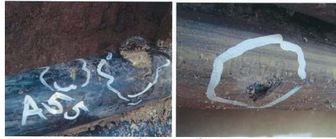
ภาพแสดงความเสียหายที่ปลอกสาย Cable ที่ Foundation #A55 และ #A67
